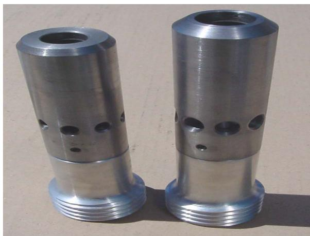
O bico de duplo venturi pode ser visto como dois bicos venturi em serie, com orifícios a meio que permitem a admissão de ar atmosférico a jusante do segmento do bico. A saída do abrasivo no duplo venturi é mais larga que nos bicos convencionais. Estas modificações permitem um aumento da área de projecção e minimização da perda de velocidade do abrasivo.
